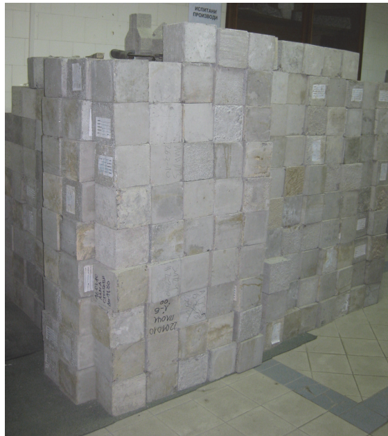
Сл. 3.1. Пробни коцки за испитување бетон 15/15/15 cm
