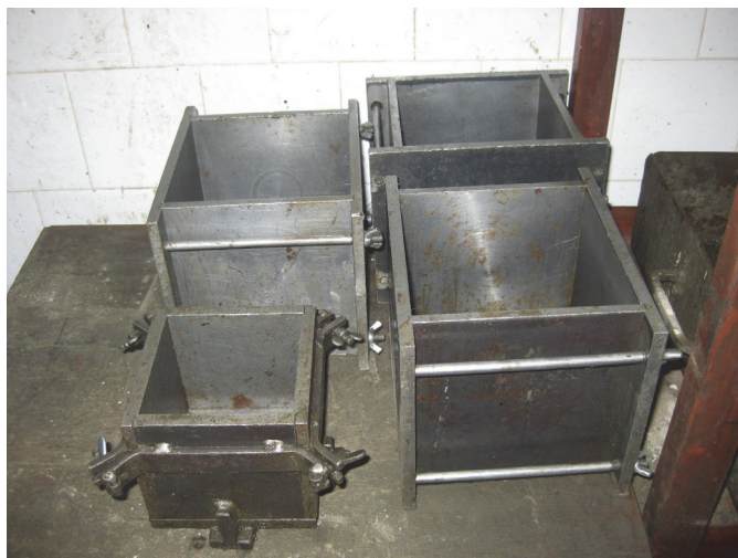
Сл. 3.2. Метални калапи за добивање на пробни коцки 15/15/15 и 20/20/20 cm
