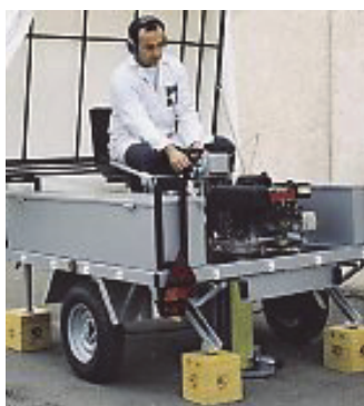
Сл. 3.9. Машина за вадење пробни тела од готови конструкции
