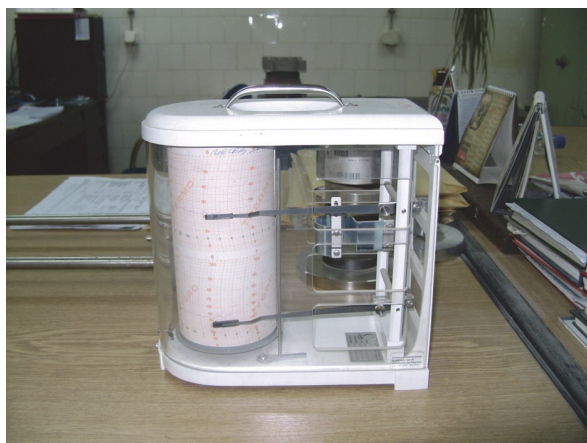
Сл 1.15. Инструменти за мерење на температурата и влажноста во просторијата
