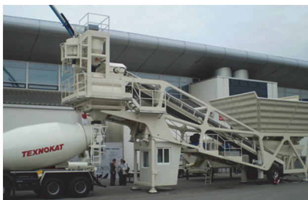
Сл. 2.7. Мобилна фабрика за бетон
