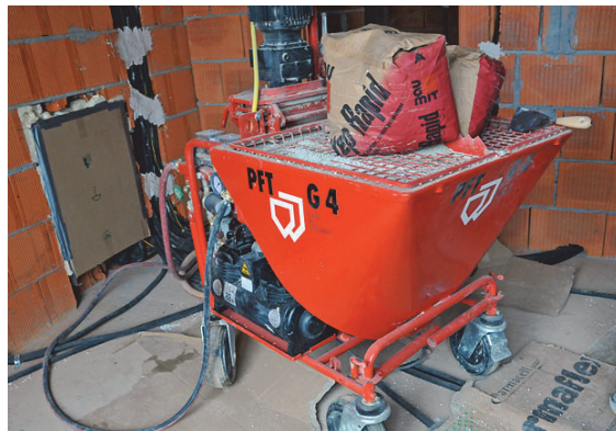
Сл. 3.15. Машина за подготовка на лесен бетон
