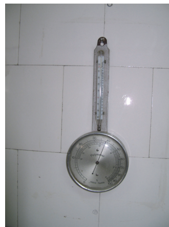
Сл 1.15. Инструменти за мерење на температурата и влажноста во просторијата
