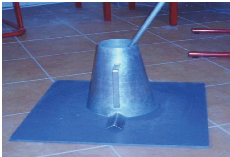
Сл. 2.2. Опрема за испитување на цементот со метод на слегнување
