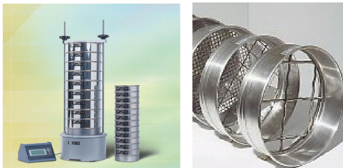
Сл. 1.26. Гарнитура сита за просејување на агрегатот
